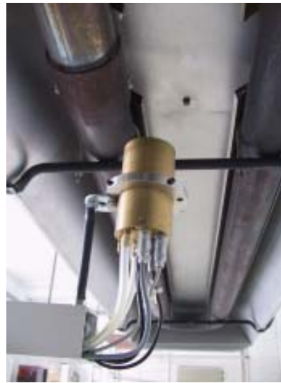
KÜBLER-RayLab beim Vermessen eines Dunkelstrahlers.
